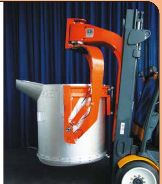
■ TM 2500 in Fahrposition, Pfanne angehoben
