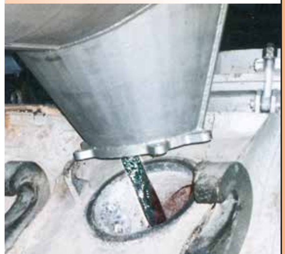
■ Pfanne beim Befüllen eines Warmhalteofens
