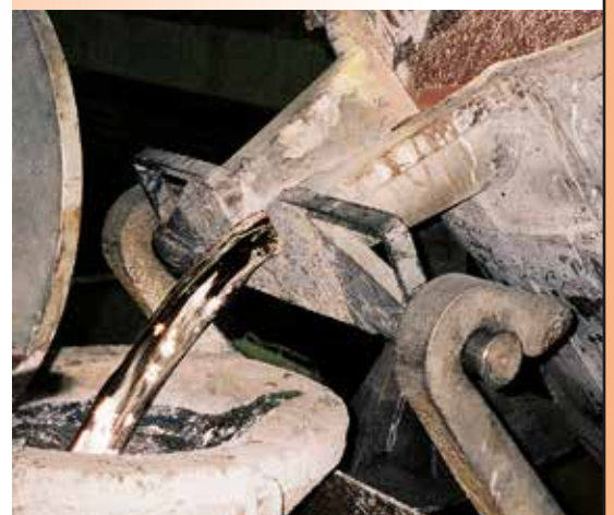
■ Pfanne andockt beim Befüllen eines Dosierofens
